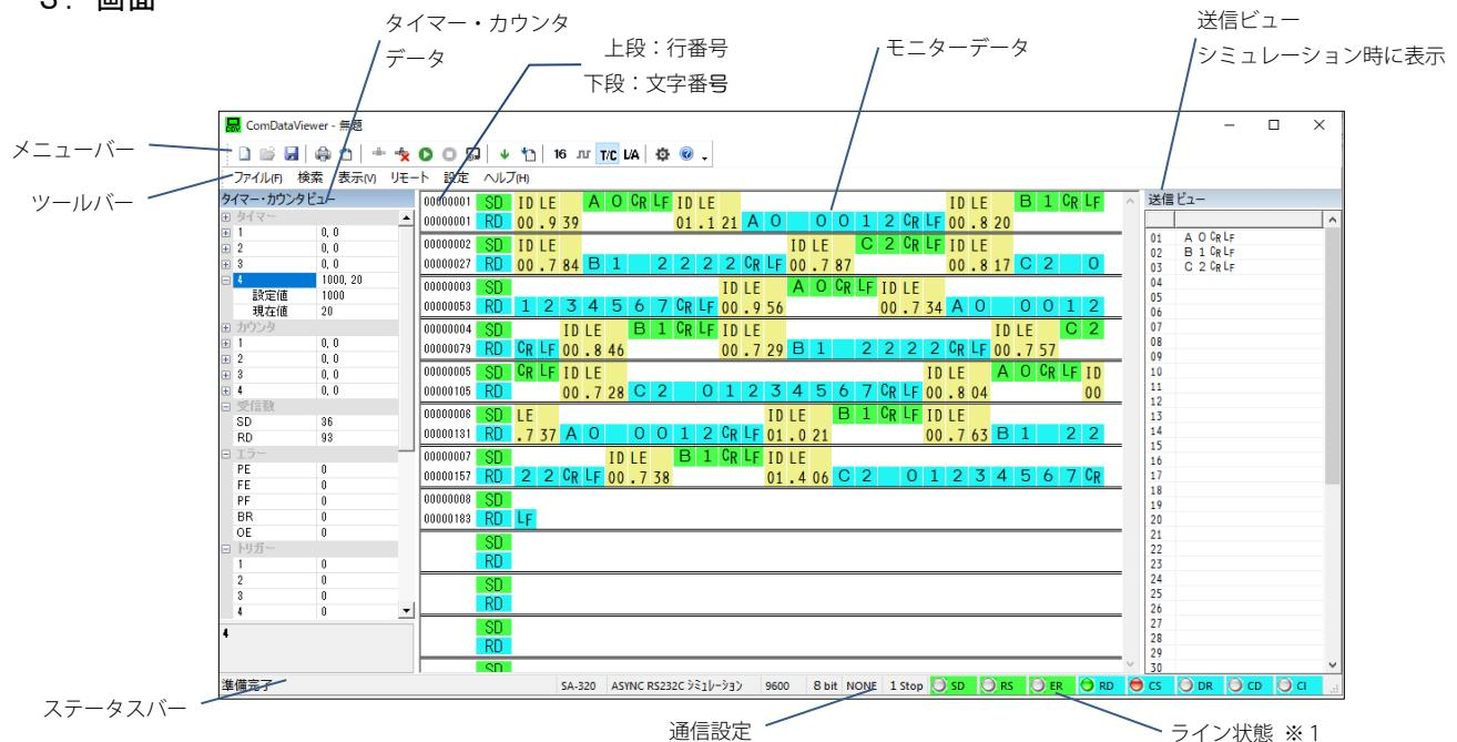
通信設定状態は現在表示しているモニタデータの設定を表示しています。
