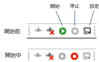
開始時の通信設定等はアナライザー本体に設定されて設定が適用されます。変更する場合は、開始前にパソコンからリモート書込にて変更しておく必要があります。
